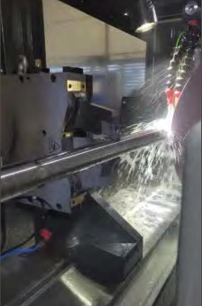
Automatische hydraulische Setzstock
